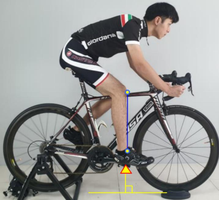
Une fois le cycliste assis sur la selle All-wings, le talon est posé sur l'axe de la pédale et la pédale est maintenue à la position 3 heures. La zone du mollet doit être perpendiculaire au sol.
