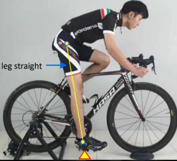
Une fois le cycliste correctement assis sur la selle All-Wings, le talon doit être dans l'axe central de la pédale (la pédale étant à la position la plus basse), la cuisse et le mollet doivent être en complète extension. Lorsque l'ischion repose sur la zone bleue (confer l'étape 1 du guide d'installation), le talon doit s'appuyer de manière stable sur la pédale. Vous aurez ainsi trouvé la hauteur de selle idéale.
