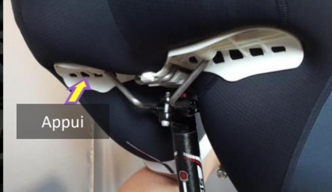
La jambe droite commence à exercer de la force de la position 12 heures à la position 5 heures. Comme les ailes de la selle touchent la base de la cuisse gauche pour empêcher le corps de glisser vers l'arrière, l'énergie cinétique du pédalage n'est de même plus perdue du côté de la jambe gauche.
